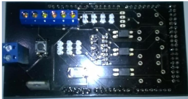
Gambar 7 Board untuk modul pengintegrasian sejumlah pin dan rangkaian elektronika pendukung
