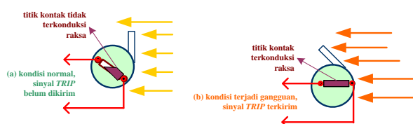
Gambar 6 Diagram skematis pengoperasian titik kontak terkonduksi raksa pada relai Buchholz untuk pemberian sinyal trip
