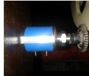
Gambar. 10. Potensiometer Pada Sistem
