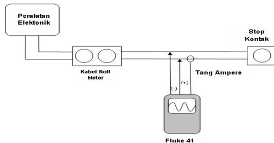
Gambar 3. Rangkaian Pengukuran Pada Peralatan Elektronik
