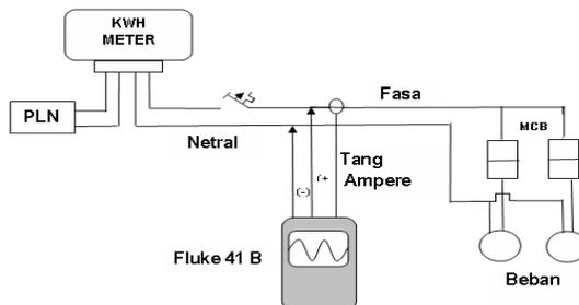
Gambar 4. Rangkaian Pengukuran Pada Kwh-Meter 1 Fasa
