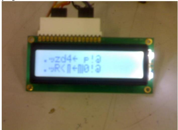
Gambar 9 Tampilan LCD Setelah Proses Dekripsi dengan Kunci yang Salah
