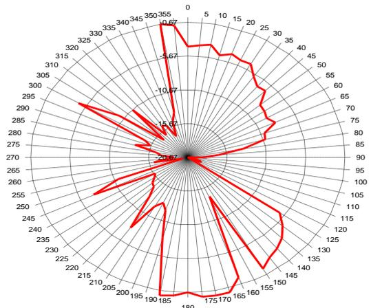
Gambar 12. Bentuk Polarisasi Antena Biquad Hasil Perancangan
