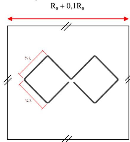
Gambar 5. Rancangan Ukuran Desain Antena Biquad
